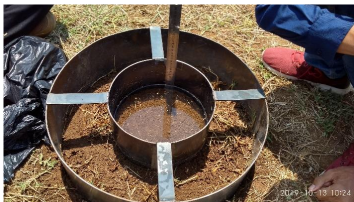
Gambar 1. Pengukuran laju infiltrasi di lapangan menggunakan alat Double Ring Infiltrometer
